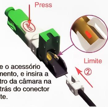
7. Pressione o acessório de travamento, e insira a fibra dentro da câmara na parte de trás do conector até o limite.
